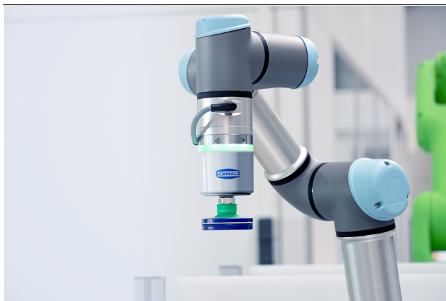
Generatore di vuoto elettrico ECBPMi per la movimentazione di lattine
